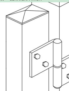
Cerniera inox di tipo a baionetta avvitata alla struttura del cancello e alla piantana tramite bulloni in acciaio inox a testa esagonale o a testa svasata.
