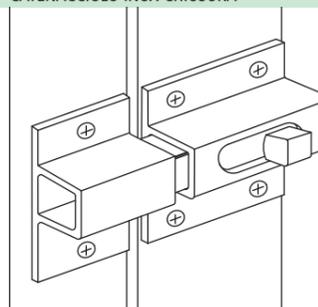
Sono dotati tutti i cancelli. La parte destra col pomolo viene fissata sul cancello con viti autofilettanti a testa svasata, mentre la boccola di incontro viene fornita a parte con viti, da fissare a posa ultimata.
