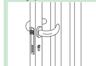
La serratura manuale con maniglia è incassata nella struttura del telaio, ed è corredata di 3 chiavi. La maniglia usata è di colore nero.
